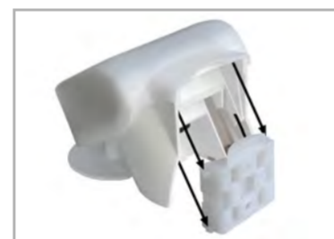
Fig. 17 Deslice el gabinete desde arriba en el soporte montado. Las espigas del soporte deben engatillarse en los rieles del gabinete.
