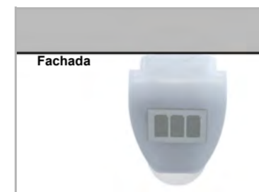
Fig. 4 La estación meteorológica debe orientarse en dirección de la fachada que se sombrará.
